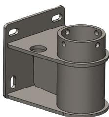
Soporte mural largo (con 291 mm de desplazamiento) fijado a estructuras verticales de hormigón o acero. Adaptador con puntos de anclaje para asegurar a dos personas (150 kg cada una) al mismo tiempo.
